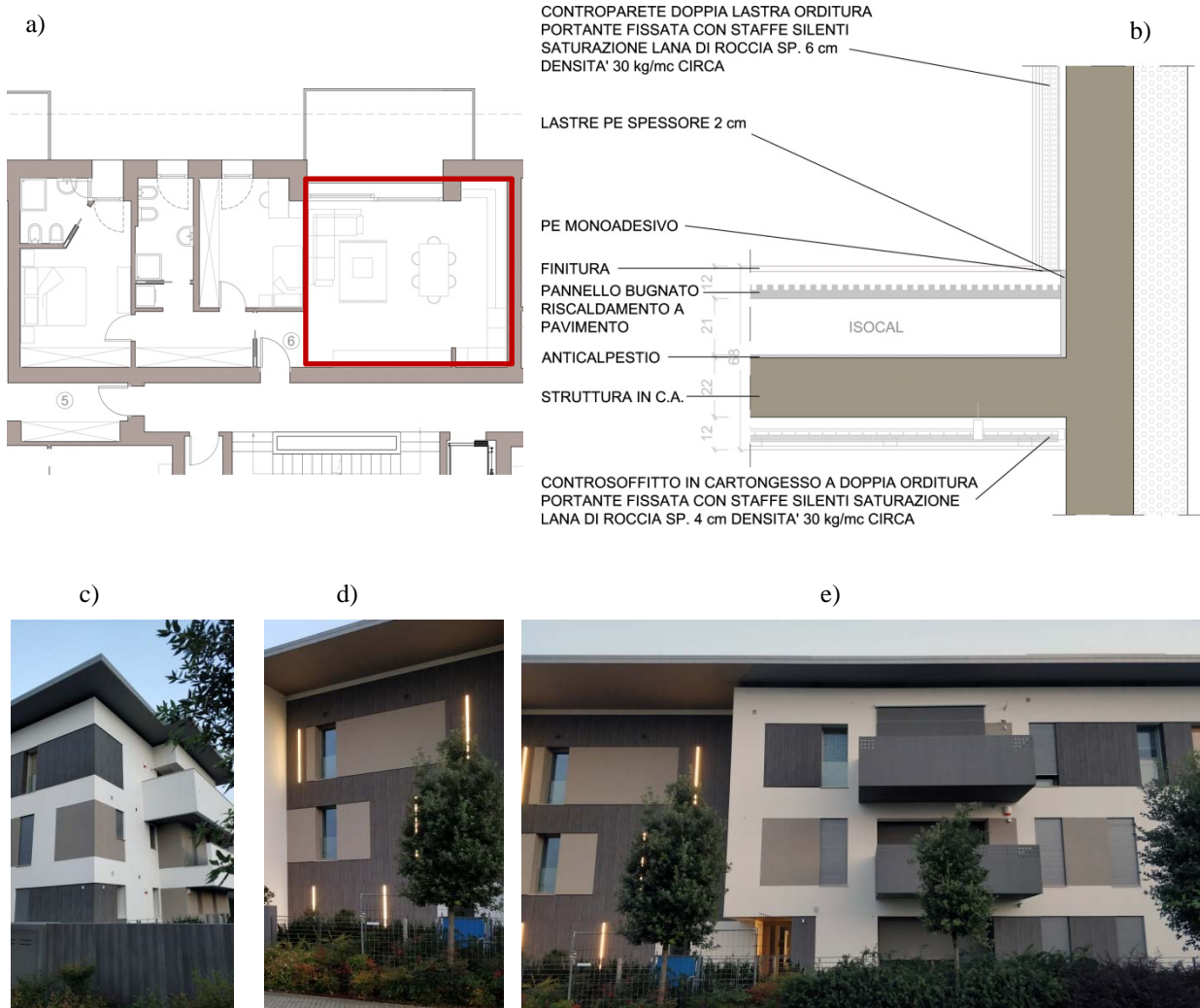
Figure 1: a) planimetria dell'appartamento oggetto di verifica (individuazione dell'ambiente ricevente); b) Stratigrafia del solaio misurato; c), d), e) Inquadramento fotografico dell'edificio.
