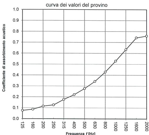
**Identificazione dell'apparato di prova:** Tubo di impedenza di 100 mm di diametro interno, intervallo di frequenza misurabile: 245-2291 Hz e 98-883 Hz. Due microfoni B&K 4190, condizionatore di carica B&K 2829, sistema di acquisizione NI DAQ 7.
