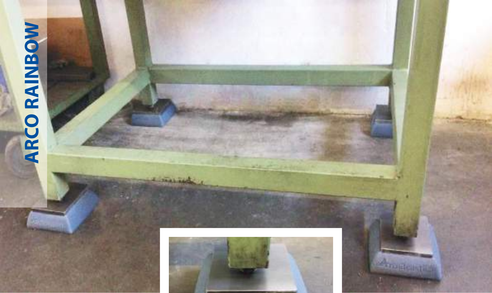
Arco Rainbow modello: elevato coefficiente smorzamento - provincia di Bergamo
